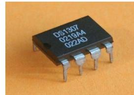
Figure (3): DS1307 RTC IC
