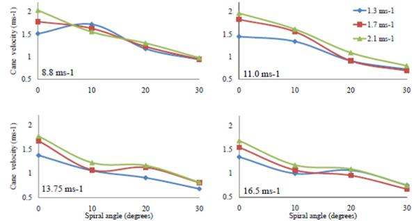
FIG.6 SENSITIVITY OF CANE VELOCITY ON DIFFERENT SPIRAL ANGLES AT VARIOUS INPUT ROLLER SPEED AND DE-TRASHER ROLLER SPEED
