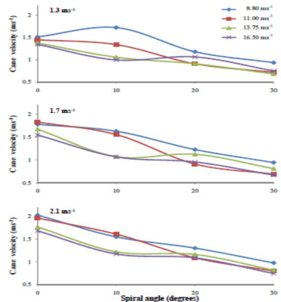
FIG. 7 SENSITIVITY OF CANE VELOCITY ON DIFFERENT SPIRAL ANGLES AT VARIOUS DE-TRASHER ROLLER SPEEDS AND INPUT ROLLER SPEEDS
