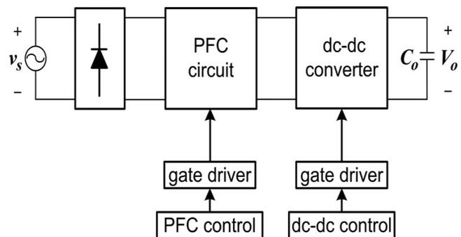
Fig. 2. Two-Stage Single-Phase PFC Converter
